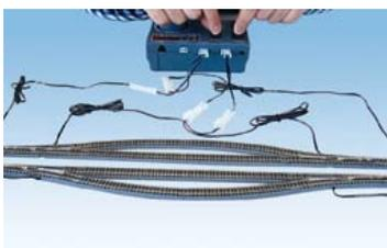
Anschluß von 4 Weichen am RC01 mit Hilfe des Y-Kabels
